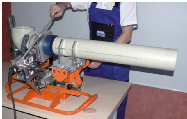
upnutí do přípravku a vycentrování, poté nahřívání
