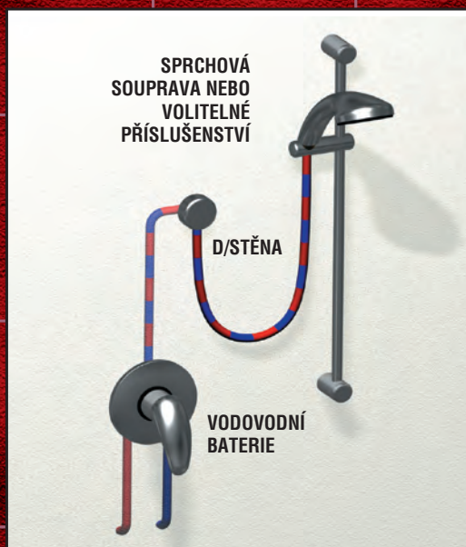
10. Sprchová podomítková baterie, stěnový vývod, sprchový komplet.
