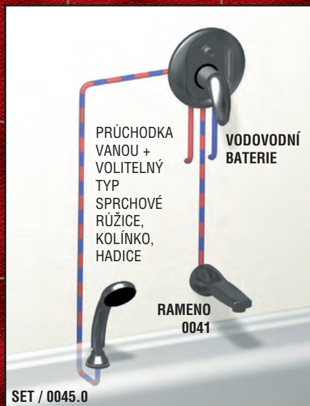
15. Podomítková baterie s přepínačem, výtahovací sprcha s hadicí 1,5 m zabudovaná v okraji vany nebo soklu, rameno.
