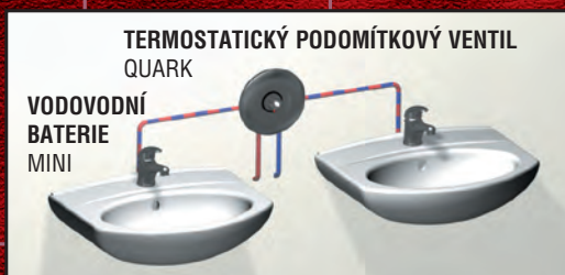
5. Termostatický podomítkový ventil, stojánkové baterie pouze na studenou (míchanou) vodu
